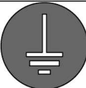
アース線は必ず接地してください。接地には AWG18(0.75mm<sup>2</sup>)以上の線材を使用して、できるだけ短くしてください。感電の恐れがあります。
